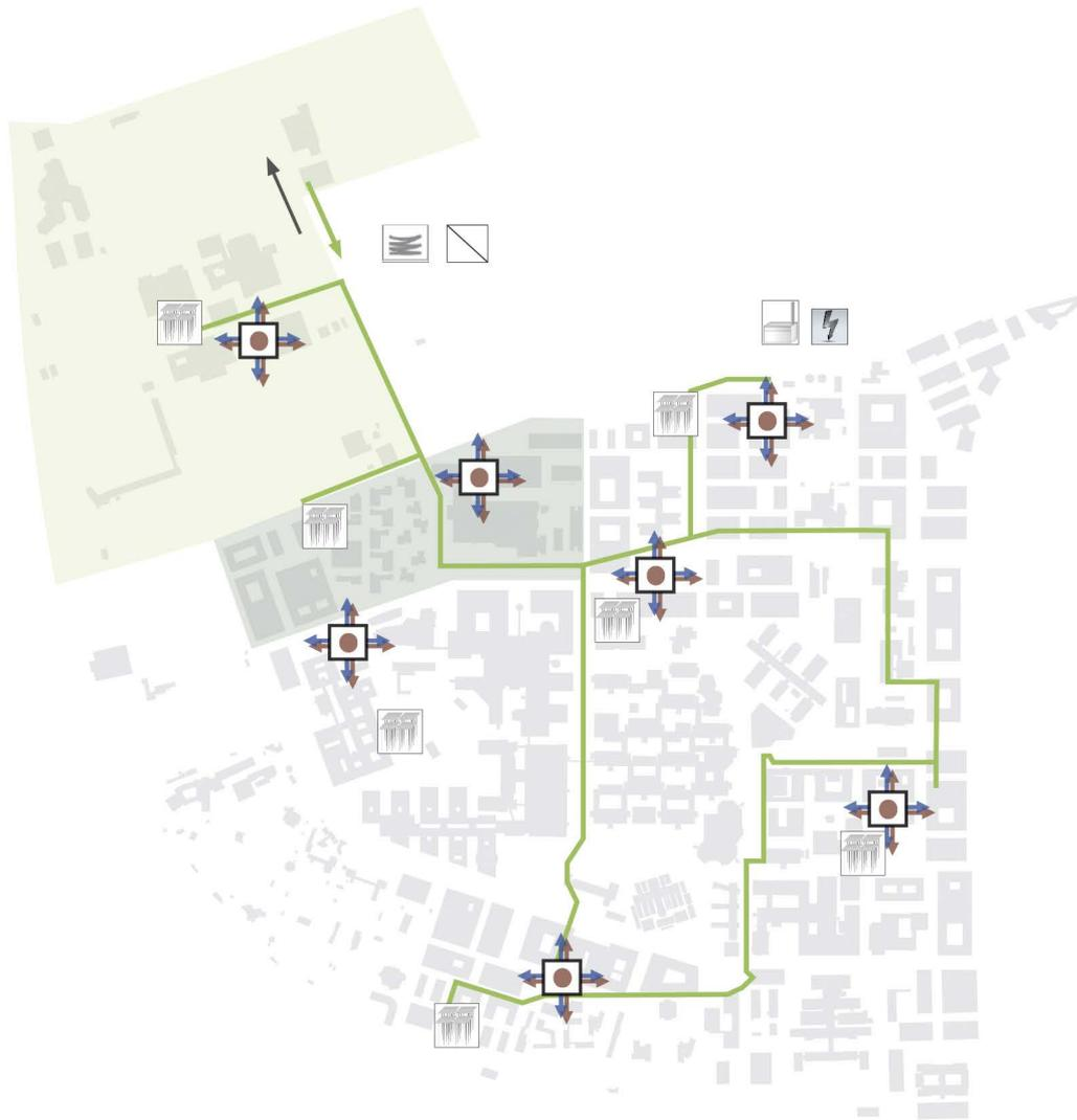
Endausbau des Anergienetzes mit Zentralen und Erdsondenfelder. Auch Wärmequellen, wie z.B. das Abwasser der Kläranlage, können eingebunden werden. Die Hochtemperaturwärme ab der Heizzentrale wird nur noch als Spitzenlast- oder Redundanzabdeckung benötigt. Biogas kann in der Heizzentrale eingesetzt werden.
