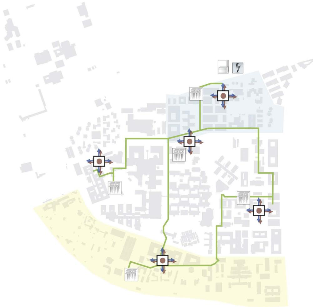
Das Anergienetz wird durch Wärmequellen und -senken und weitere Clusterzentralen und Erdsondenfelder ergänzt. PV und PVT-Anlagen sowie E-Ladestationen werden kontinuierlich ausgebaut.
