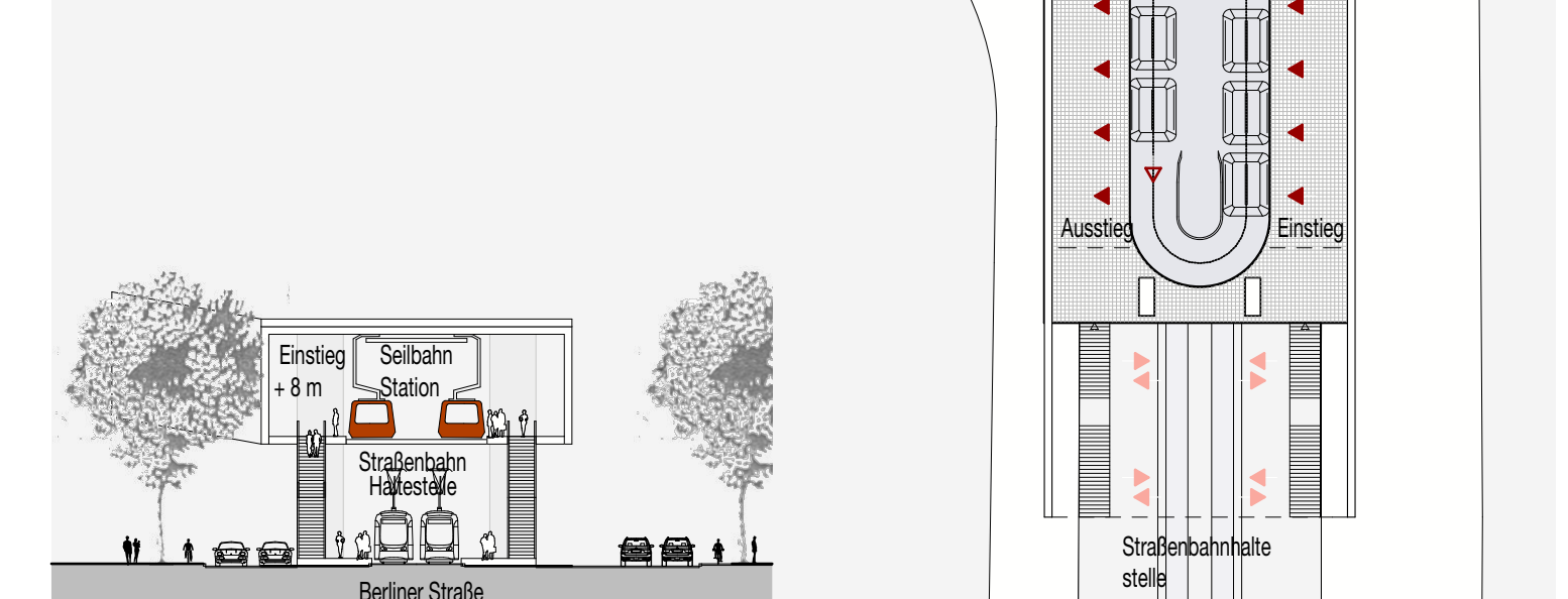
Seilbahnstation Berliner Straße - Grundriss und Schnitt
